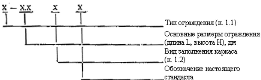
Пример условного обозначения марки ограждения лестничного марша внутренней лестницы длиной 2700 и высотой 900 мм, решетчатого:
